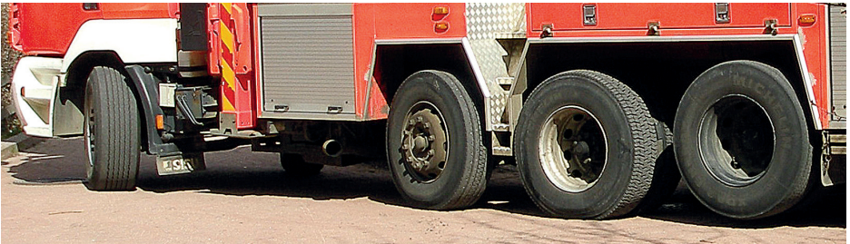
3-akselinen teli eli trippeli. Tässä etummainen nousee sekä kääntyy, keskimmainen vetää ja takimmainen nousee.
